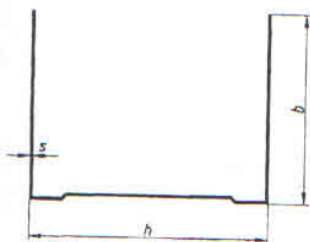
Рис. 3 - U-образный профиль для потолка (UD), U-образный профиль для стены (UW) (образец).
